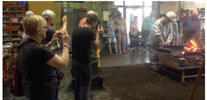
Das Aluminium wird heute in einem mit Drehstrom über Heizspiralen betriebenen Ofen erschmolzen. Im Ofen befindet sich ein Thermoelement. Wenn dort eine Temperatur von 900°C angezeigt wird, ist der Tiegel mit der Schmelze zum Abguss bereit. Die Mitarbeiter der Schaugießerei übernehmen dann den Abguss der eingeformten Objekte.
