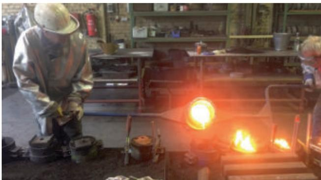
Anstelle des früher verwendeten Stahles ist nun Aluminium im Schmelztiegel. Mit Formsand werden die Figuren und Modelle in Ober- und Unterkästen abgeformt.
